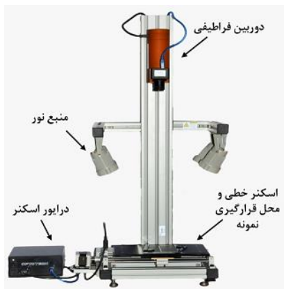
شکل (۴): دوربین فراتیفی همراه با اسکنر خطی
